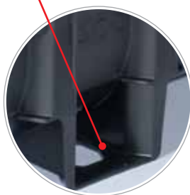
Монтажные «карманы», позволяющие бетону заполнить всё пространство вокруг канала. Придают ему прочность и препятствуют смещению или всплыванию при монтаже.
