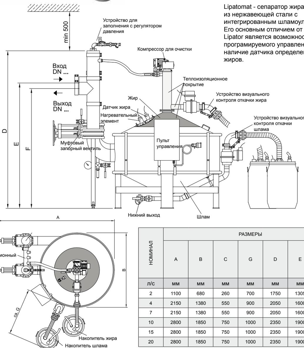
Lipatomat - сепаратор жира из нержавеющей стали с интегрированным шламоуловителем. Его основным отличием от сепаратора Lipator является возможность программируемого управления, а также наличие датчика определения уровня жиров.
