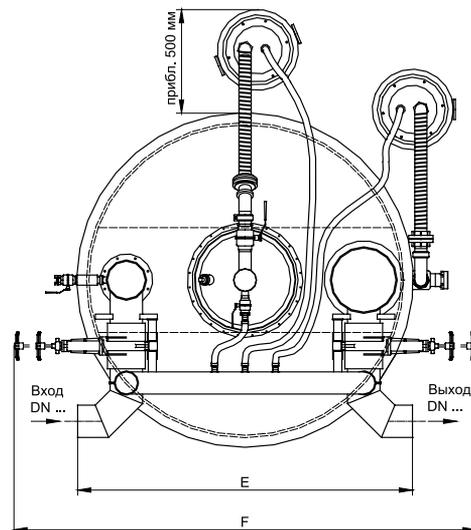
Этот тип сепараторов используется в помещениях, где отсутствует возможность подъезда ассенизаторской машины (высокие этажи ТРЦ, подземные этажи и т.п.).
