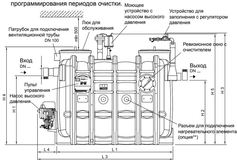
На изображении показан сепаратор номиналом 4л/с, обслуживаемый справа. При левостороннем обслуживании все элементы будут расположены в зеркальном отражении. Артикулы в таблице представлены для сепараторов, обслуживаемых справа. Возможна аналогичная комплектация сепаратора с левосторонним обслуживанием.
