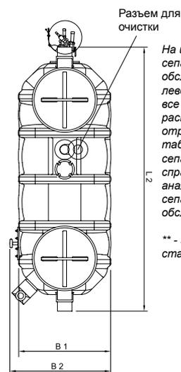
На изображении показан сепаратор номиналом 4л/с, обслуживаемый справа. При левостороннем обслуживании все элементы будут расположены в зеркальном отражении. Артикулы в таблице представлены для сепараторов, обслуживаемых справа. Возможна аналогичная комплектация сепаратора с левосторонним обслуживанием.
