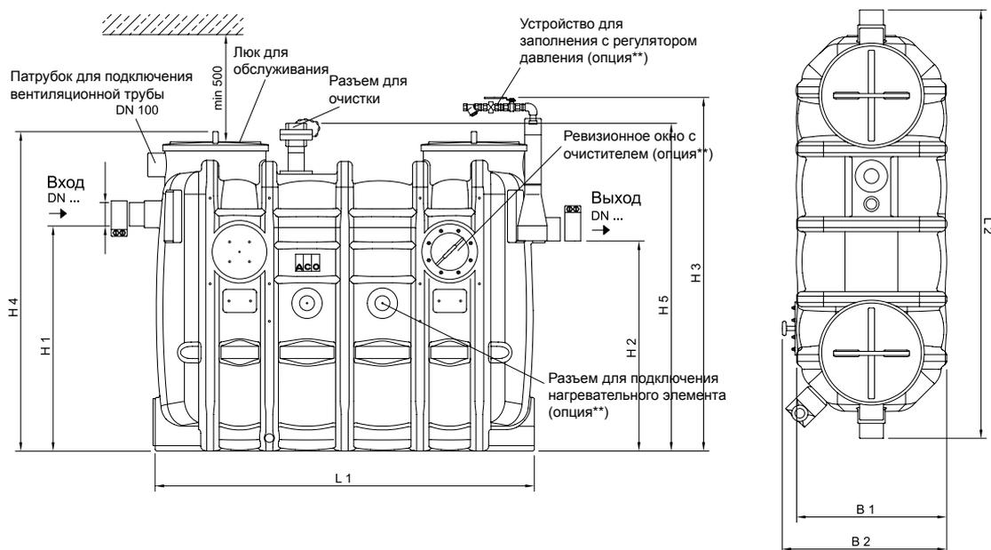
На изображении показан сепаратор номиналом 4л/с, обслуживаемый справа. При левостороннем обслуживании все элементы будут расположены в зеркальном отражении.
