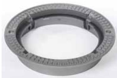
Чугунная рама системы Bituplan для монтажа в асфальтированную поверхность, класс нагрузки D400. Рама монтируется в асфальт катком, при реконструкции дорожного покрытия вынимается и используется повторно.
