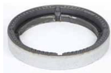
Круглая рама Lift из чугуна и бетона. Монтаж в бетонное покрытие, классический монтаж в асфальт класс нагрузки В 125, D 400. При реконструкции покрытия дороги рама переставляется на новую высоту.
