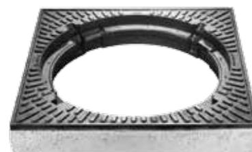
Квадратная рама Lift из чугуна и бетона. Монтаж в бетонное покрытие, классический монтаж в асфальт класс нагрузки В 125, D 400. При реконструкции покрытия дороги рама переставляется на новую высоту.
