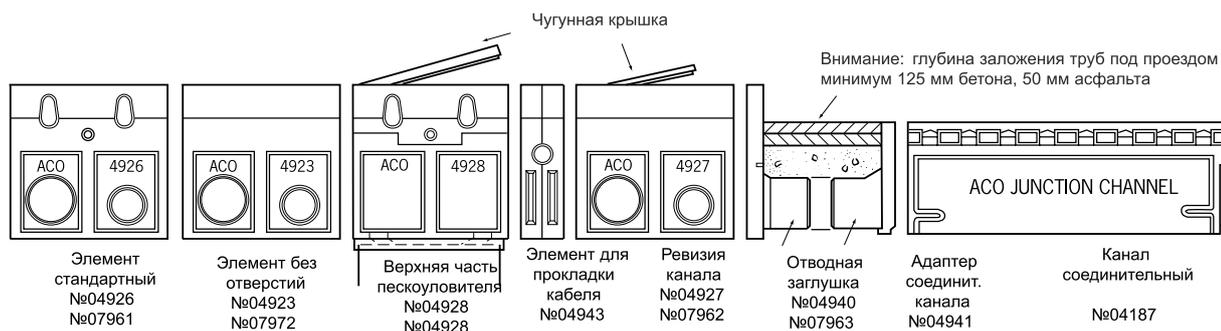
Внимание: торцевые стенки для элементов KerbDRAIN изготавливаются левыми либо правыми, в зависимости от места установки
